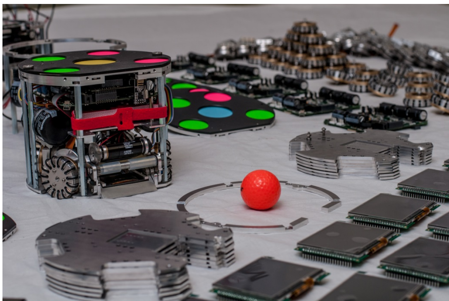
Abbildung 1: Neue Robotergeneration der Small Size League der TIGERS Mannheim in Einzelteilen
